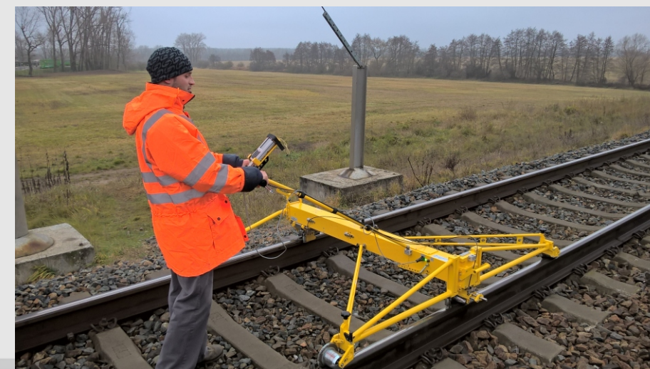
Měření v koleji č. 1 měřícím vozíkem KRAB Light /prosinec 2015/
