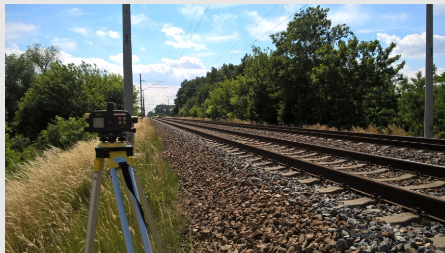
Nivelační přístroj Leica SPRINTER 150 M během měření /červen 2015/
